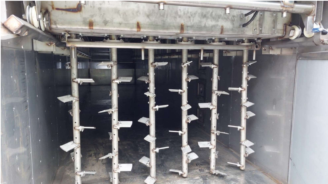
Abb. 8: Mischwerk der DükonaR-Anlage
