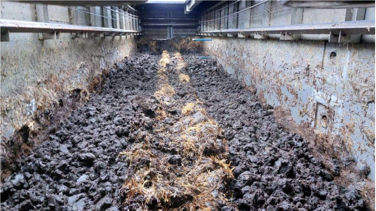
Abb. 3: Bindiges und plastisch-elastisches Kompostgut aufgrund mangelnden Wasseraustrags – keine ausreichende Kompostqualität
