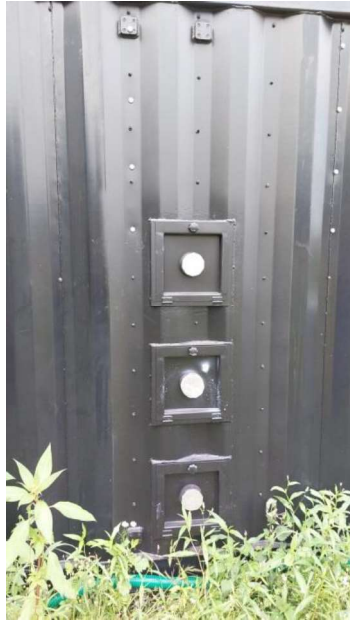
Abb. 9: Öffnungsklappen im Container zur Probenahme
